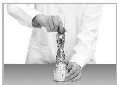
トルクゲージ ねじってパーツの強度確認
