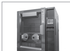
恒温槽 温度環境の変化でおもちゃが変形しないか確認
