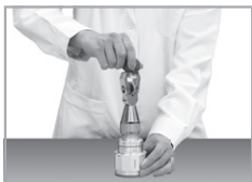
トルクゲージ ねじってパーツの強度確認
